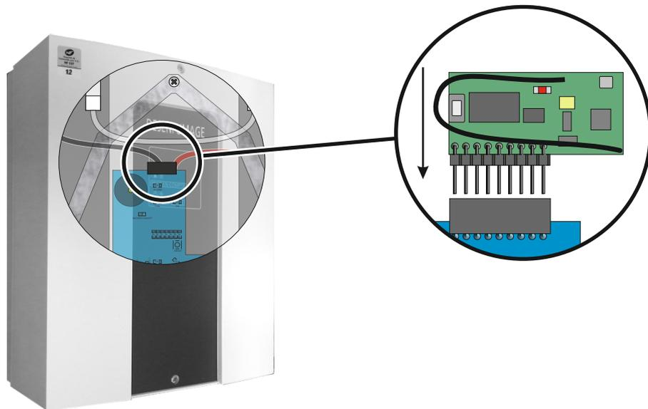
Insérer le module réception radio dans le connecteur se trouvant en haut du circuit imprimé de la centrale REFLEX.
