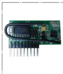
Module Récepteur Radio pour options confort.
