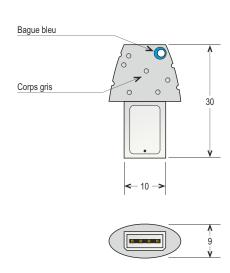
La clef de programmation permet de sauvegarder un programme se trouvant dans l'horloge électronique journalière, ou de restituer un programme se trouvant dans la clef vers l'horloge électronique journalière.
