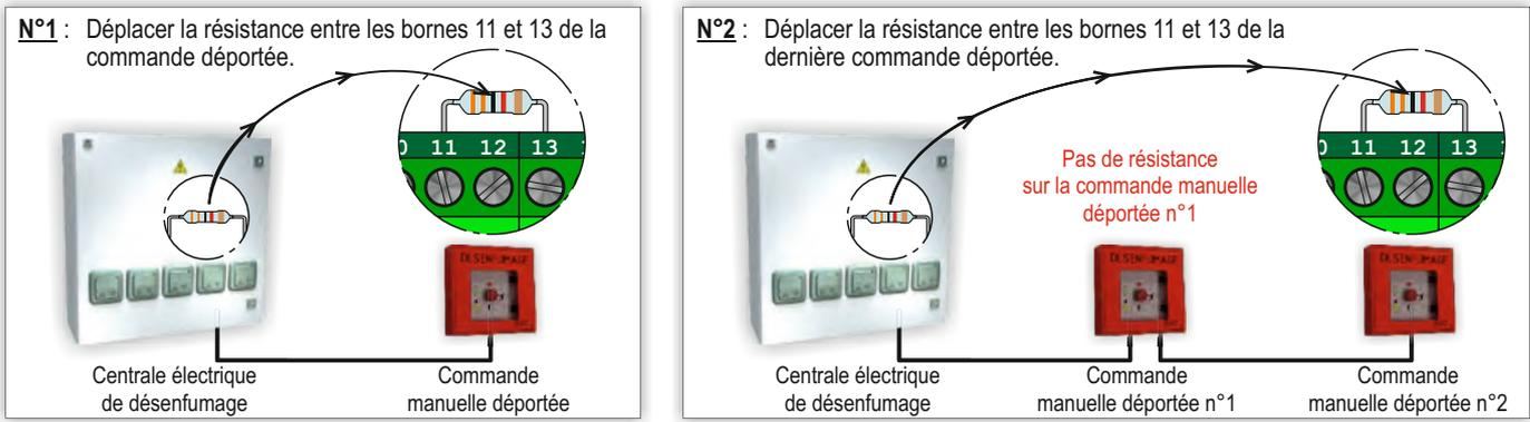
**RACCORDEMENT DE COMMANDE(S) MANUELLE(S) DÉPORTÉE(S) SUR UNE CENTRALE ÉLECTRIQUE DE DÉSENFUMAGE**
