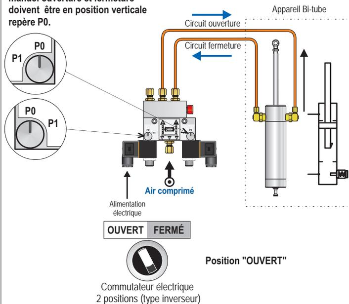
**Les molettes de pilotage manuel ouverture et fermeture doivent être en position verticale repère P0.**
