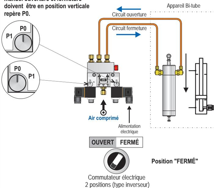
**UTILISATION DU PILOTAGE MANUEL (bloc non alimenté en électrique)**
