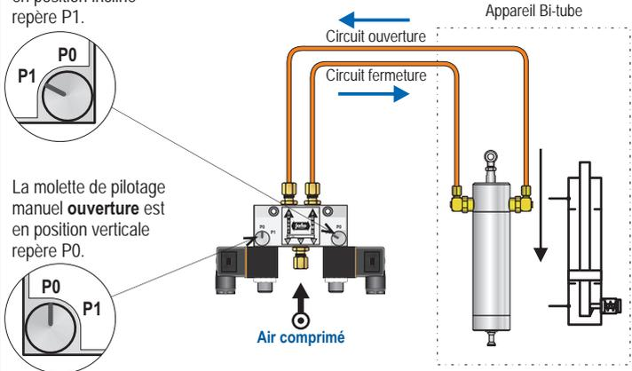
Les pilotages manuels se substituent au commutateur électrique en façade. Ils ne peuvent être opérationnels que si les déclencheurs électriques sont hors tension.
