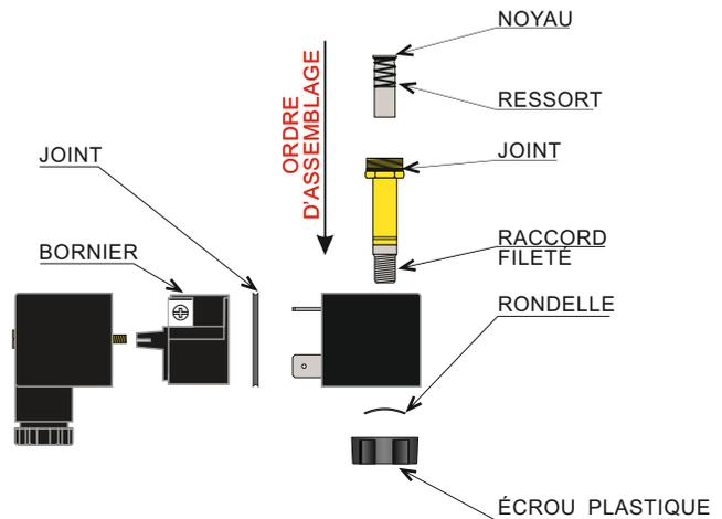
**MONTAGE DU DÉCLENCHEUR SUR LE BLOC AÉRATION**
