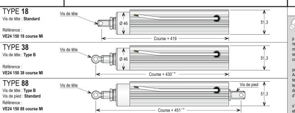
Vérin électrique 24 V courant continu conçu pour lever, tirer, pousser et déplacer en remplacement de toute opération manuelle tout en assurant une sécurité et une qualité de travail constantes.
