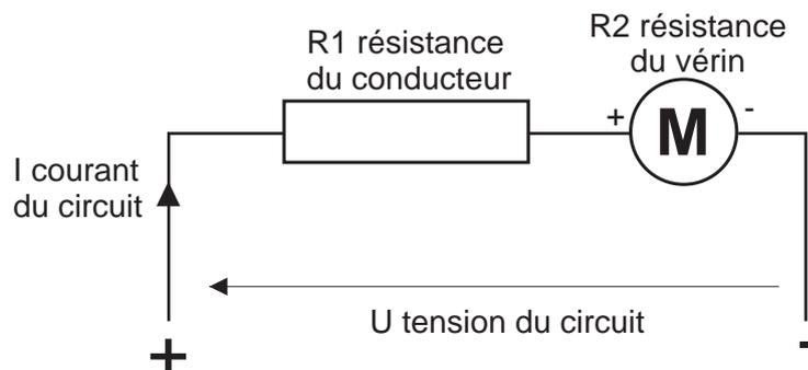
Conséquences de la section du conducteur sur l'installation:
