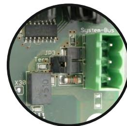
On peut relier plusieurs centrales électriques de désenfumage grâce à la connexion d'un BUS. Cela permet d'associer des fonctions de confort entres plusieurs centrales.
