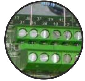
Pour effectuer la réinitialisation de la centrale et la fermeture des DAS, on branche un contact sec sur les bornes 39 et 41, en faisant un pont entre les bornes 37 et 39 et en laissant la résistance de 33K $\Omega$  entre les bornes 35 et 41.
