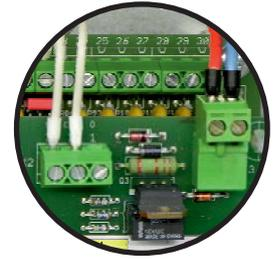
Raccorder au bornier la ligne de commande électrique provenant d'un C.M.S.I., d'un D.A.D, ou d'une autre source, en veillant à bien respecter les tensions et les polarités.
